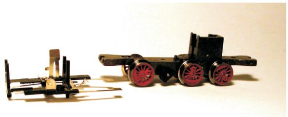
Stromführende Kontaktfedern für den Motor im Analogbetrieb.
